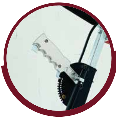
Manopola per la regolazione e l'impostazione della profondità di taglio
