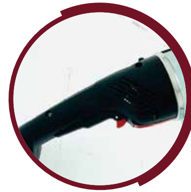
Dispositivo di accensione sull'impugnatura
