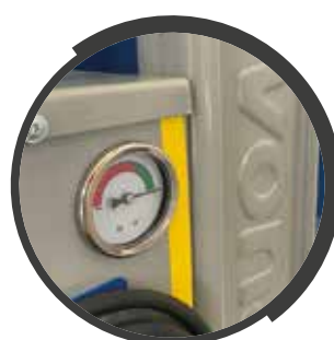
MANOMETRO SEGNALAZIONE STATO FILTRO
