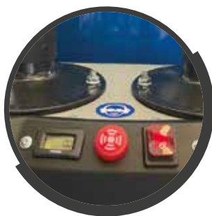
CONTA ORE E DISPOSITIVO SEGNALAZIONE SONORA
