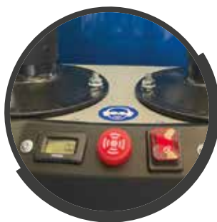
CONTA ORE E DISPOSITIVO SEGNALAZIONE SONORA
