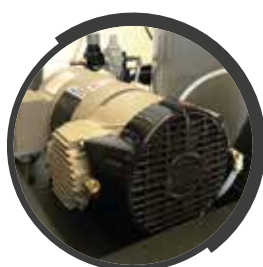
COMPRESSORE A SECCO THOMAS
