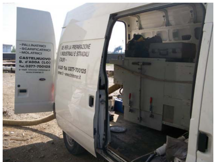
6 - L'unità mobile che trasporta la pallinatrice e consente una maggiore elasticità operativa.
